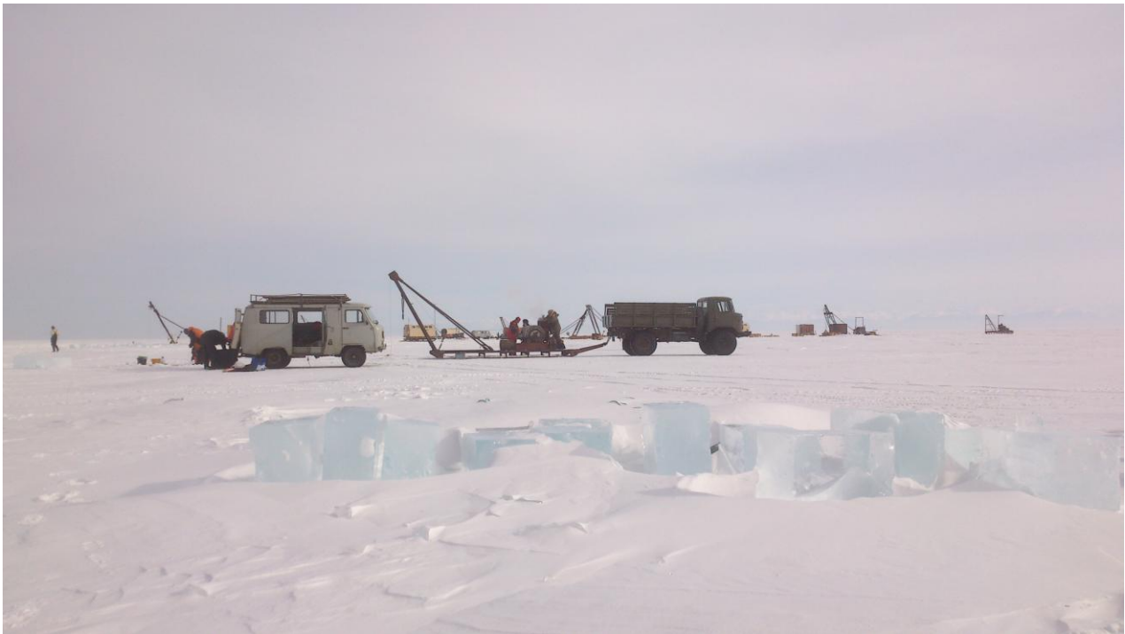
Bildlegende: Unsere kleine Expedition auf dem 80 cm dicken Eis des Baikalsees. Wir warten auf den Sedimentkern der gerade mit der grossen Seilwinde im Vordergrund aus 1300 m Tiefe geborgen wird. Im Hintergrund sind die Seilwinden zu sehen welche im Winter gebraucht werden um die vielen Sensoren des Neutrinoobservatoriums zu begutachten.
